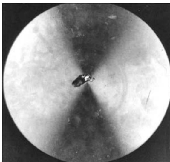
Рисунок 4 – Усадочная раковина в слитке диаметром 300 мм при постепенном (3 мин) снижении мощности
