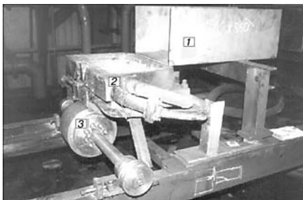
Рисунок 8 – Технологическая оснастка, смонтированная на подвижной раме: 1 – нерасходусный короб; 2 – промежуточная емкость; 3 – барабан-кристаллизатор
